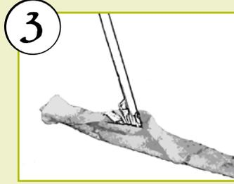
3 Gelösten Schmutz mit Wischer aufnehmen und mit klarem Wasser sorgfältig 2x nebelfeucht (**nicht nass**) nachwischen. Bei strukturierten, gebürsteten oder gefasteten Oberflächen unbedingt ein geeignetes Microfasertuch verwenden.
